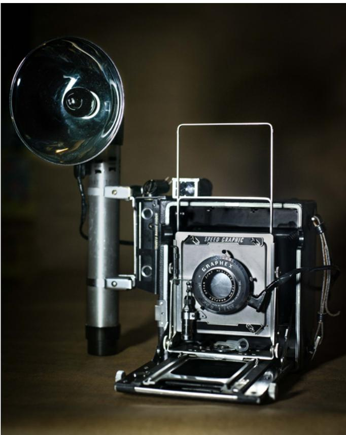
Appareil Speed Graphic de Graflex, avec son flash à ampoule infrarouge (photo Wikimedia Commons, Daniel Teoli Jr.)
